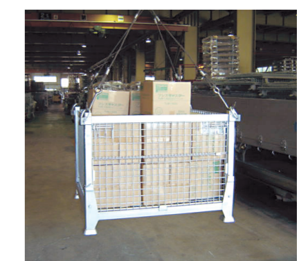
建築資材の積み下ろし
